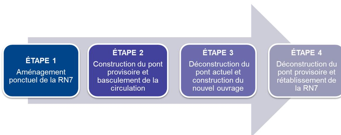
Le pont provisoire offre les mêmes caractéristiques qu'un ouvrage neuf. Les usagers continueront à circuler sur 3 voies dans les deux sens de circulation mais son tracé en courbe implique une réduction de la vitesse à 70 km/h pendant la durée des travaux. Sur la RN7, la circulation s'effectuera sur 1 voie dans chaque sens et la vitesse sera limitée à 50 km/h.
